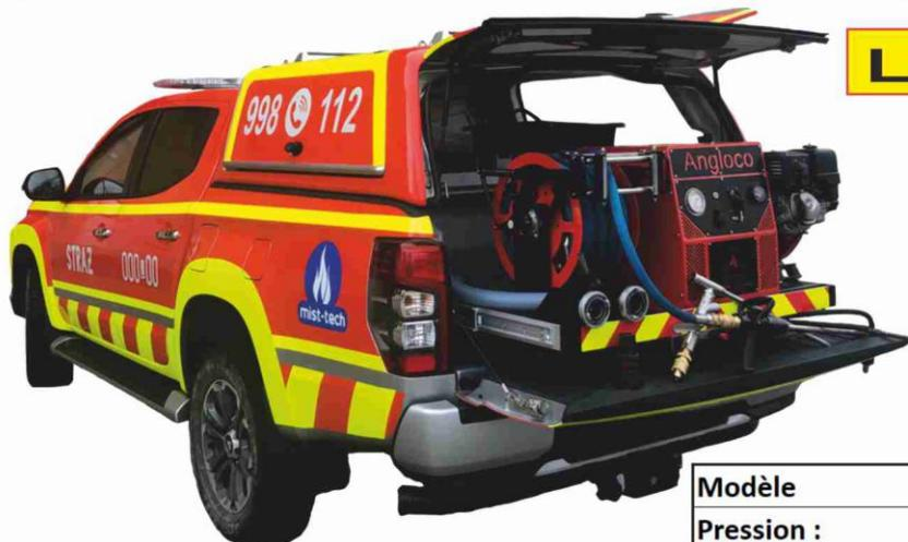
• Le VIRP MIST-TECH est doté d'un réservoir d'eau intégré de 100 à 500 litres (ou plus sur demande).
