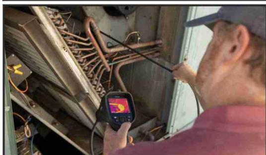
Le VS290 est également très apprécié pour toutes les inspections industrielles de surfaces difficiles d'accès : la caméra thermique identifiant les différences de température, elle permettra de diagnostiquer non seulement les anomalies thermiques (surchauffe d'une canalisation, d'un câble électrique, d'un connecteur...) mais également les fuites de liquide...
