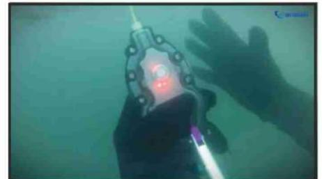
Le clignotement du câble peut être modifié à partir du touret ou de la commande déportée, permettant ainsi une communication entre les intervenants, même quand le câble est immergé.
