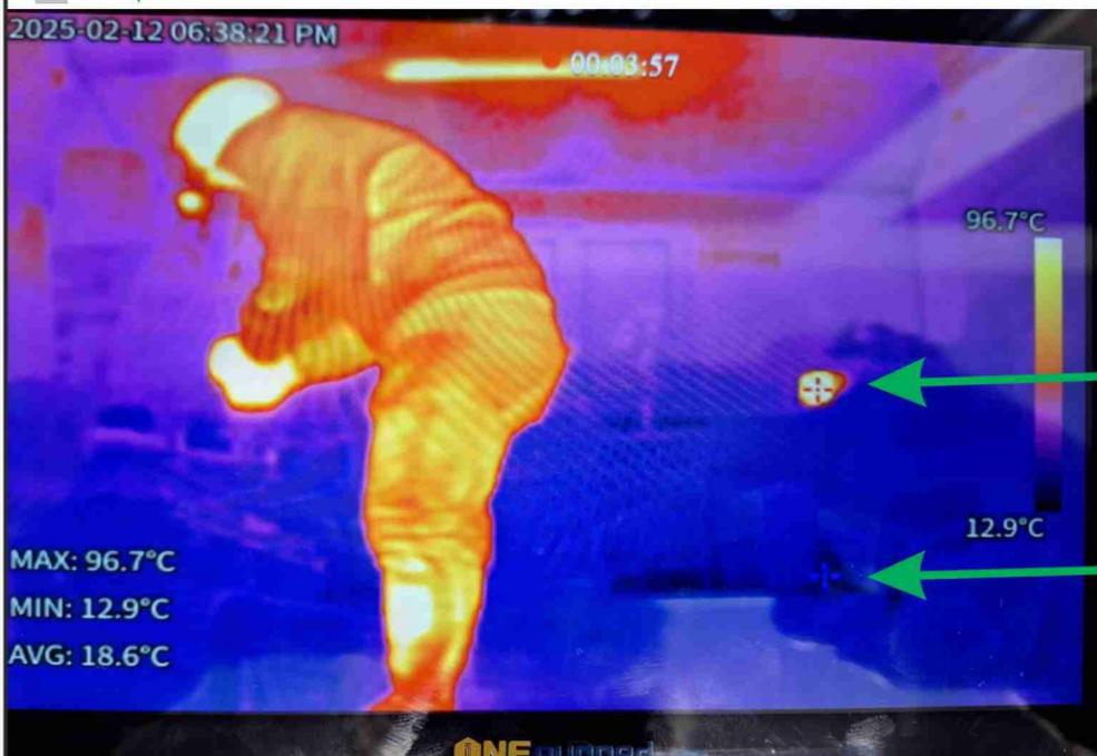
La cámara térmica puede medir temperaturas de -20 a 550 °C. La temperatura más alta de la escena apuntada se muestra en la parte superior del cursor a la derecha y la más baja en la parte inferior del cursor.
