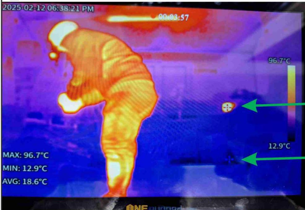
La caméra thermique peut mesurer des températures de  $-20$  à  $550^{\circ}\text{C}$ . La température la plus élevée de la scène visée s'affiche en haut du curseur à droite et la plus basse en bas du curseur.
